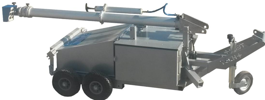
TOGOTO : le Kit TOGOTO est un système mobile multifonction, il est composé d'un châssis hyper léger en aluminium, de 2860 W de batteries, d'une unité générale gérant la charge à partir du 220 VCA ou d'un panneau solaire, et d'un mât de 5 mètres élevé pneumatiquement, ensuite construisez vous-mêmes votre TOGOTO ! c'est à la carte : Eclairage, gyrophare, mégaphone, sirène, caméra de surveillance, captage de l'air, etc...
