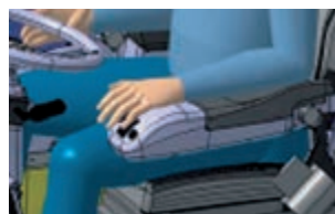
Direction électrique Pour des cycles de travail rapides et sans effort, la direction peut s'effectuer à l'aide d'un contacteur servo-électrique. 2 modes de direction : 1 mode pour les trajets sur longues distances, 1 mode pour une maniabilité accrue dans les espaces exigus. La direction électrique permet de reprendre le contrôle à tout moment avec la direction conventionnelle.
