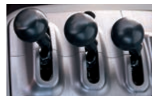
Mini-leviers servocommandés 3 leviers pour commander les bras de levage, le godet et le circuit hydraulique auxiliaire. Contacteurs pour AV/PM/AR, rétrogradage forcé, retour en position d'attaque, arrêt automatique des bras de levage et mode de flottement.
