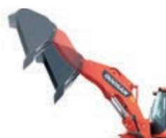
Bras de levage à grande hauteur Portée supérieure et hauteur accrue au pivot de godet.
