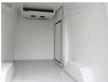
Revêtement intérieur lisse teinté blanc. Plancher antidérapant avec passages de roue caissonnés.
