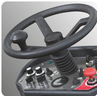
Panneau de commande simple et intuitif comprenant : un compteur horaire, un indicateur de niveau de charge de la batterie, un témoin de réservoir vide et un indicateur de marche avant/arrière.
