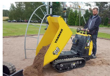
La capacité de charge utile du C08 est de 800 kg, ce qui permet de couvrir une grande majorité de travaux. Il est conçu pour évacuer les matériels de construction et les déchets des chantiers et convient également aux transports de toutes sortes. Le carrier C08 est performant sur tous les types de terrains. Il garantit polyvalence et productivité. Ses dimensions compactes lui permettent de travailler dans des espaces très confinés où sa largeur est un véritable atout
