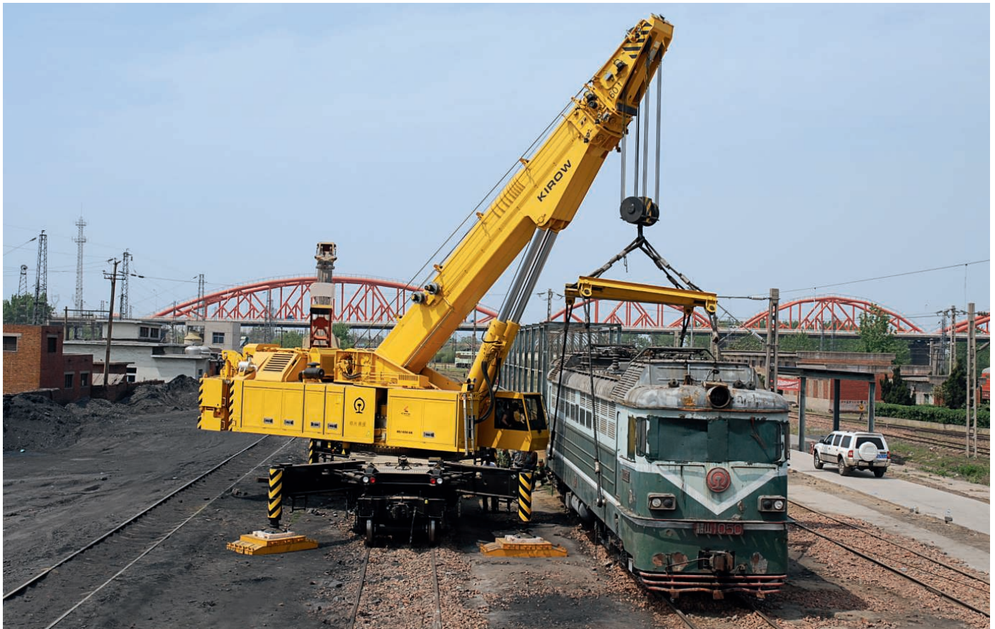
↑ Multi Tasker 1600 avec étayage complet
