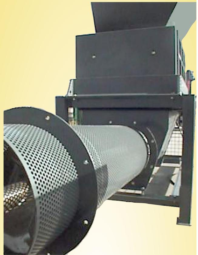
Vis d'extraction et tamis de séparation des phases solide et liquide (option)
