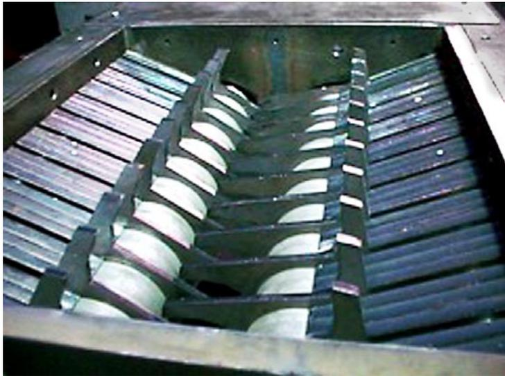
Le bloc de coupe du broyeur blik B 600 Perf 950 ne se contente pas d'effectuer de multiples perforations aux récipients plastiques . Il broie aussi bien les contenants en verre, les pièces métalliques ou autres avec une incroyable rapidité
