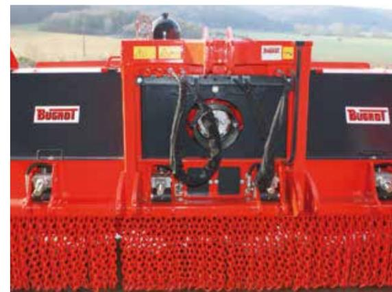
La sensibilité de la sécurité des enclumes est contrôlable et visible depuis le poste de conduite grâce à un manomètre.
