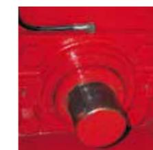
Comme la gamme de BPM et OBLX, les enclumes sont réglables hydrauliquement depuis le poste de conduite. En cas de corps étranger, une sécurité non-stop protège le rotor. En effet, les enclumes sont en plusieurs parties montées sur vérins couplés à un amortisseur hydraulique (boule d'azote).
