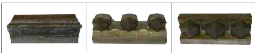
Au choix, 3 types de masses sont montables sur les rotors de BP et BPE.
