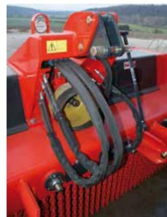
Comme sur les BPM, la sensibilité de la sécurité des enclumes est contrôlable depuis le poste de conduite grâce à un manomètre. La position du 3<sup>e</sup> point a deux positions afin de s'adapter à tous les tracteurs et garder un angle de cardan optimum.
