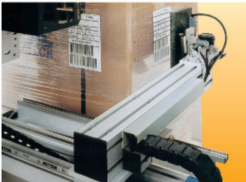
— Système d'impression/pose des étiquettes sur palettes —
