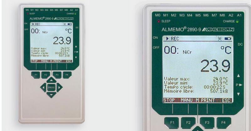
**Appareil de mesure ALMEMO® de précision avec fonction d'acquisition de données multiples fonctions pour tous les domaines d'application précision accrue de la mesure, cadence de mesure élevée. Grand affichage graphique, éclairage lumineux. 9 entrées mesure. Fonctionnement sur batterie, charge dans l'appareil.**
