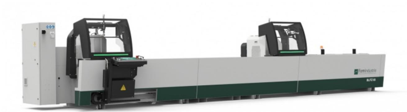
**Tronçonneuse à deux têtes avec déplacement motorisé de la tête mobile et inclinaison des têtes contrôlée électroniquement**
