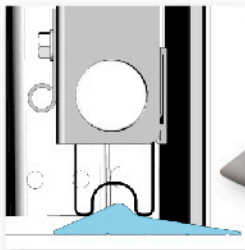
Seuil caoutchouc Permet de rattraper les imperfections du sol et d'assurer l'étanchéité
