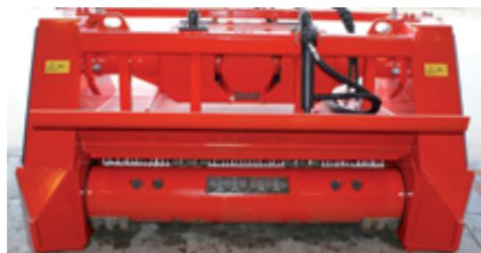
Le rotor en acier à haute limite élastique est plein et tourné dans la masse, les pièces d'usure ont une disposition hélicoïdale afin d'avoir un broyage uniforme.
