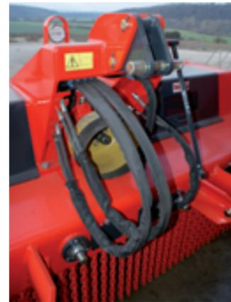
Comme sur les BPM, la sensibilité de la sécurité des enclumes est contrôlable depuis le poste de conduite grâce à un manomètre. La position du 3° point a deux positions afin de s'adapter à tous les tracteurs et garder un angle de cardan optimum.
