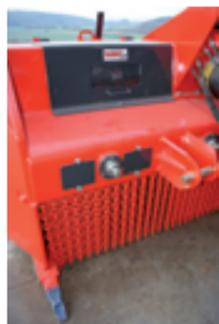
En cas de corps étranger, une sécurité non-stop protège le rotor. En effet, les enclumes sont en plusieurs parties montées sur vérins couplés à un amortisseur hydraulique (boule d'azote).
