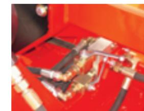
Dans l'utilisation avec les enclumes toujours fermées (granulométrie la plus fine possible), deux vannes permettent d'isoler le broyeur du tracteur tout en conservant la sécurité non-stop active.
