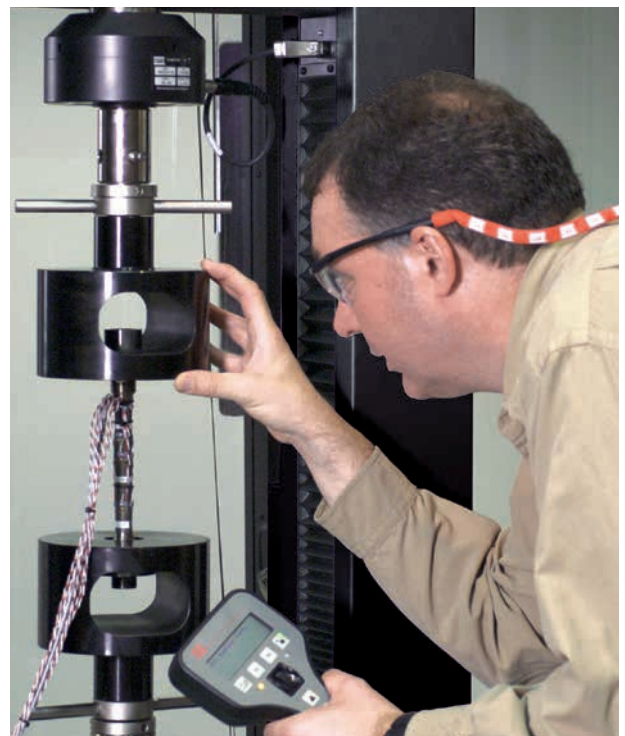
Alignement du bâti
