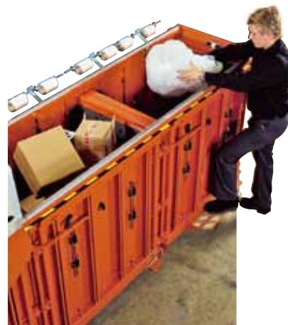
Un système automatique breveté d'éjection de la balle est installé dans chacune des chambres. La sécurité de l'opérateur est notre principale priorité.
