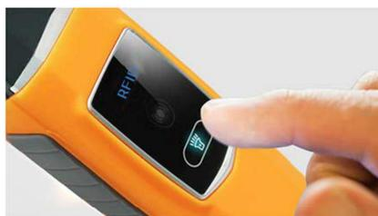
Le lecteur RVTV4 intègre également une lampe torche déclenchée par l'appui sur un bouton inductif (non mécanique). Celle-ci s'éteint seule au terme d'un temporisation définie.
