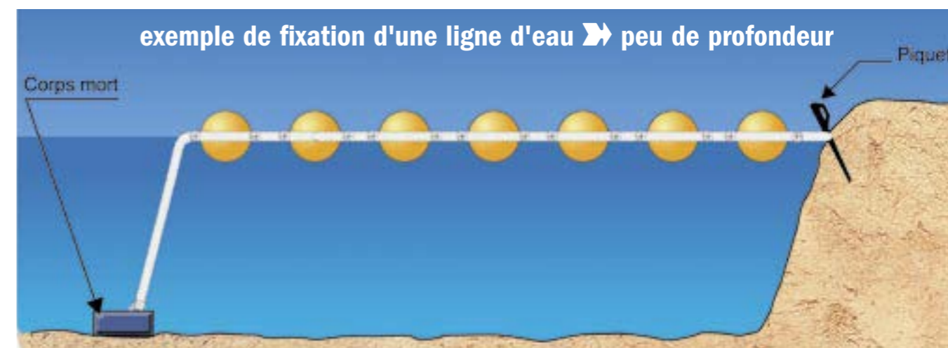
Les extrémités de la ligne sont fixées, d'une part sur un piquet fiché sur la plage, d'autre part sur un corps-mort.
