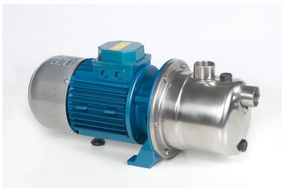
La machine est une pompe électrique centrifuge auto-amorçante de type jet, adaptée au pompage et à la mise sous pression d'eau propre jusqu'à 60 ° C. Elle est équipée d'un éjecteur qui garantit une capacité d'aspiration et d'auto-amorçage élevée et un fonctionnement même en présence de gaz dissous dans le liquide. La série ECC JET est en acier inoxydable AISI 304 et technopolymère, elle est munie d'un moteur à courant continu 12V ou 24V.
