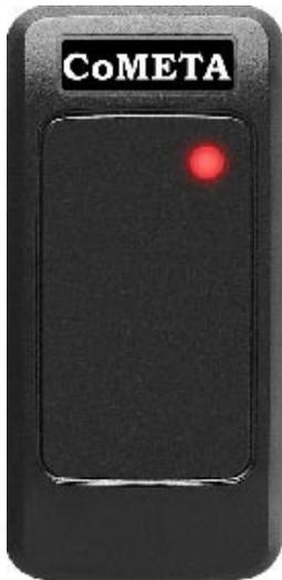
Lettore RFID di prossimità indoor/outdoor (IP65) di carte e tags a 125 kHz standard ISO11784/85. Formato di uscita Wiegand 26 bits con tamper anti-rimozione, buzzer interno e LED per la segnalazione della lettura per l'utente finale.
