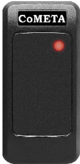
Lettore RFID di prossimità indoor/outdoor (IP65) di carte MIFARE standard ISO14443 Type A. Formato di uscita Wiegand 26 bits con tamper anti-rimozione, buzzer interno e LED per la segnalazione della lettura per l'utente finale.
