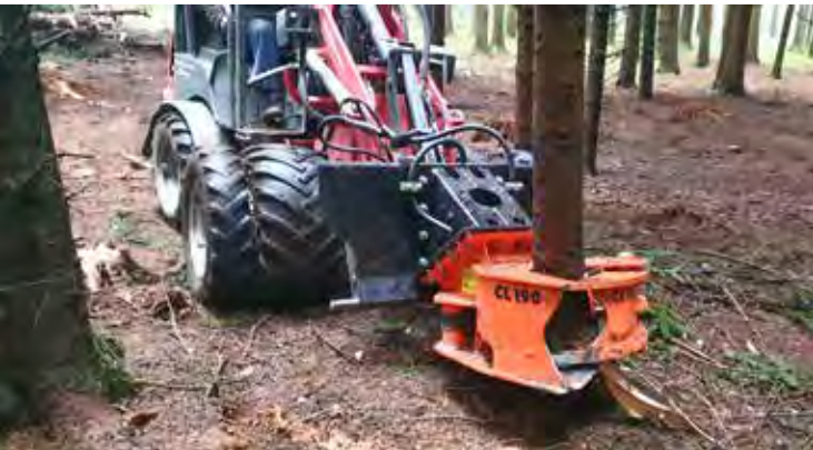
Woodcracker® CL190 pour bois tendre jusqu'à 25 cm.
