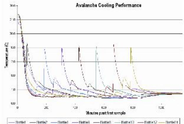
Isco technologie de contrôle de la température avec précision conserve les échantillons à 3 ° C - même dans des conditions difficiles indiqués ci-dessus (40 ° C ambiante 20 ° C la température de l'échantillon).
