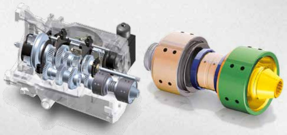
Transmission à variation continue de 0 à 50 km/h
