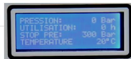
Cet écran indique la pression actuelle, le nombre d'heures d'utilisation, la pression d'arrêt ( modifiable directement à partir de l'écran d'accueil, en utilisant les flèches ▲ et ▼) et la température ambiante. A partir de celui-ci, appuyez sur le bouton "PAGE" pour passer à l'écran de réglage du Compresseur.
