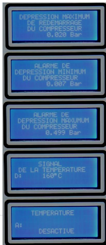
Activation, ou pas, des capteurs de température. Il est possible de connecter 6 capteurs de température: A, B, C, D, E et F. En cas de rupture du câble d'alimentation d'une des sondes, une alarme se déclenche indiquant quelle capteur a un problème. Par défaut, seul le capteur du dernier étage (D) est activé.
