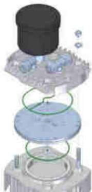
Regardez attentivement l'image ci-dessous pour le positionnement exact du clapet et assurez-vous que le mot "TOP" ou la lettre "T", inscrit sur la plaque de clapet, soit orienté vers le haut. Si les joints ne sont pas en bon état, ils doivent être remplacés.
