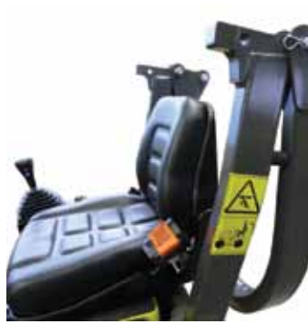
Structure ROPS pliable pour un transport facile
