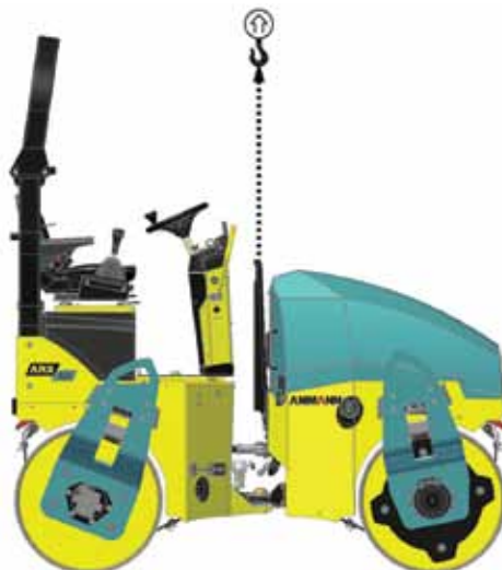
Le point de levage central est un équipement standard sur le modèle ARX1/un équipement en option sur le modèle ARX2
