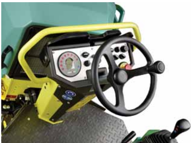
Un tableau de bord isolé des vibrations
