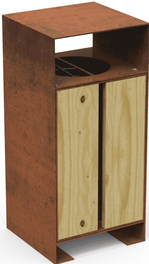
Corbeille avec **structure en acier Corten** de 6mm. Lattes en bois de pin traitées en autoclave vide et pression classe IV contre les vrillettes, termites et insectes. Seau intérieur en acier galvanisé.
