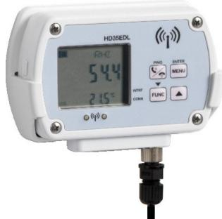
Enregistreur sans fil de température, d'humidité et de pression atmosphérique. Écran LCD personnalisé (seulement avec l'option L). Il stocke les mesures dans sa mémoire interne (22000 échantillons) et transmet automatiquement les données enregistrées à l'unité de base à intervalles réguliers ou sur demande.
