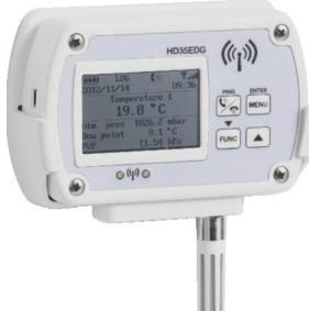
Enregistreur de données sans fil de température, d'humidité et de pression atmosphérique. Écran LCD graphique (uniquement avec l'**option G**). Il stocke les mesures dans sa mémoire interne (22000 échantillons) et transmet automatiquement les données enregistrées à l'unité de base à intervalles réguliers ou sur demande.
