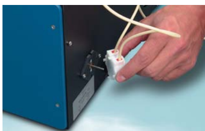
Accès rapide à la pompe péristaltique de prélèvement de l'échantillon située à l'arrière du BASIC
