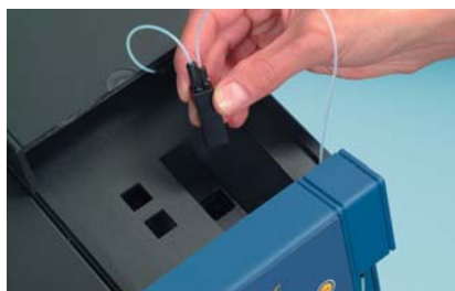
Utilisation de la cuve à circulation 30 µl ou utilisation cuve à cuve (cuve plastique jetable ou cuve verre)
