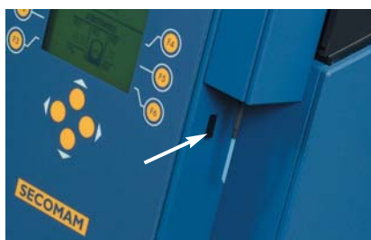
Détecteur infrarouge, déclenche automatiquement l'aspiration de l'échantillon
