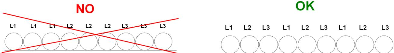
Fig. 1 - Installation de câbles d'alimentation électriques longs
