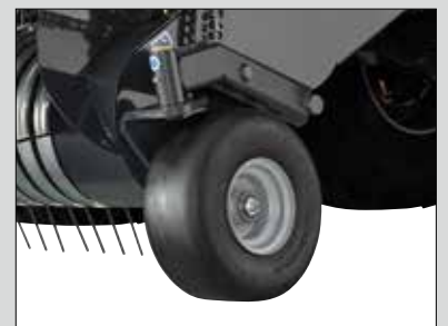
Roues de jauge de pick-up pivotantes et semi-pneumatiques
