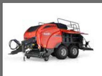
Capot et coffres de stockage de la ficelle
