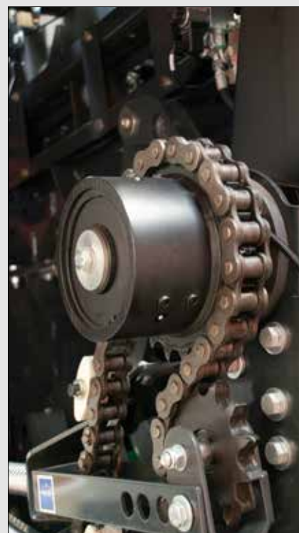
Limiteur à déclenchements du ROTOR INTÉGRAL
