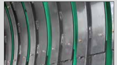
Plaques Téflon facilitant le flux pour la chambre de pré-compression
