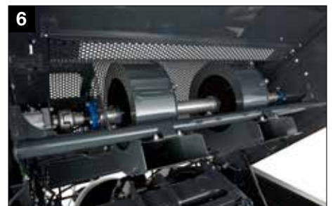
6 Turbines de nettoyage de la zone de liage
