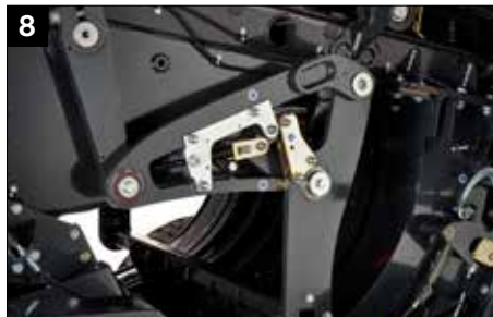
Chambre de pré-compression POWER DENSITY
