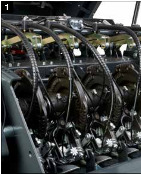
1 Nœud double nœud avec surveillance électronique de série
