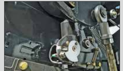
Système réglage électrique de la longueur de balle
