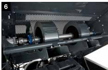
Turbines de nettoyage de la zone de liage
