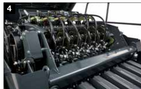
Nœud double nœud avec surveillance électronique de série
