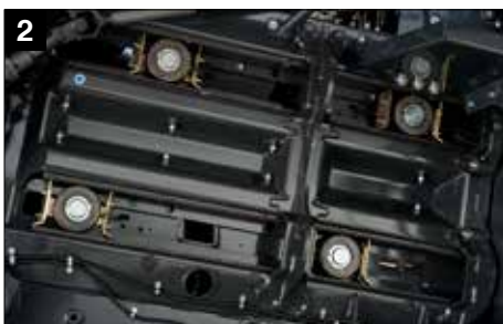
28 Galets de piston graissés ultra-robustes
