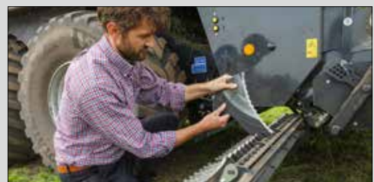
Système de cassette à couteaux coulissants unilatéraux
