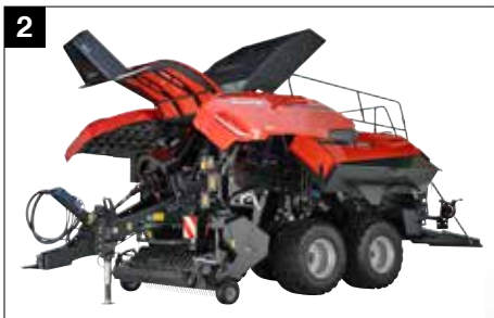
2 Compartiments à ficelle pivotants pour une maintenance aisée
