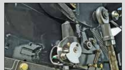
Système de réglage électrique de la longueur de balle
