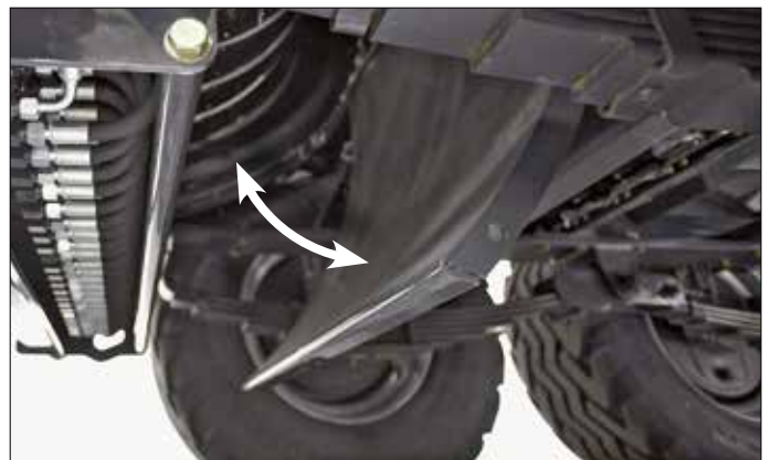
Trappe de visite de la chambre de pré-compression
