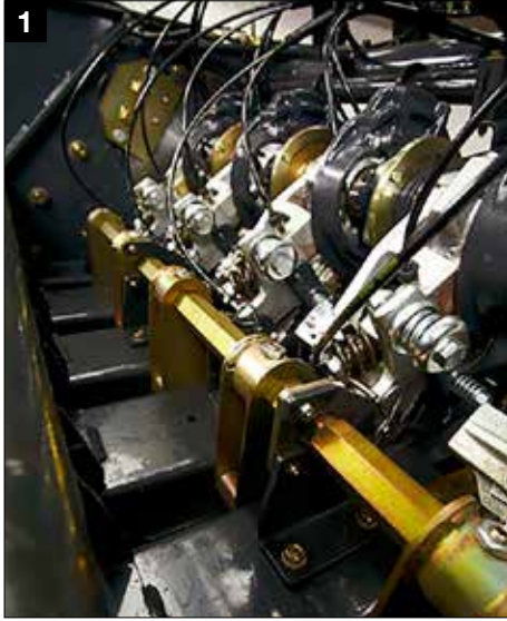
1 Système de liage TWIN STEP
