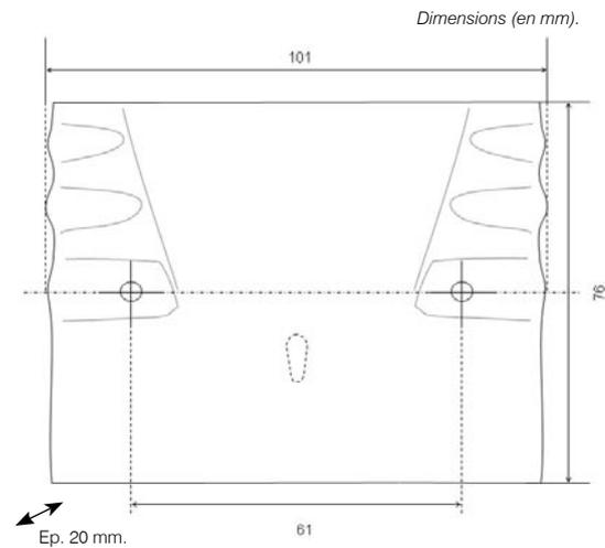
La fixation du LXS par deux vis est invisible grâce à deux caches vis amovibles qui s'intègrent parfaitement au design du lecteur
