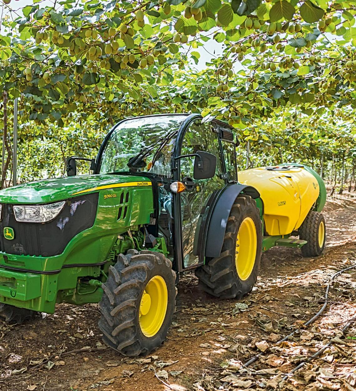
Des manœuvres parfaites en bout de champ plus faciles : le nouveau système d'angle de braquage est muni d'un capteur d'angle de braquage qui désenclenche le pont avant mécanique pour faciliter la prise des virages.
