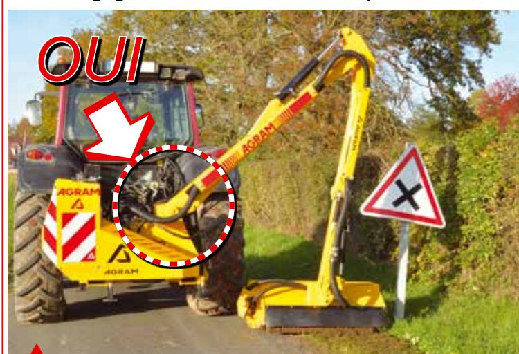
► Travail rapproché sans contrainte sur la machine. Encombrement minimum sur la voirie. Travail précis et facile autour des obstacles. Annulation des efforts transmis par le bras (pas d'effet levier sur le tracteur).
