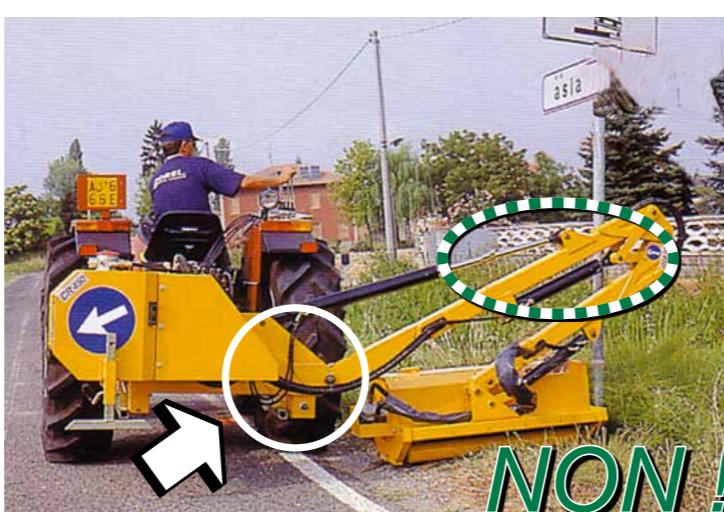
► Risque de détérioration de la machine. Cinématique bridée. Tête de rotor moins rentrée au transport. Secousses violentes transmises au chauffeur par effet de levier.
