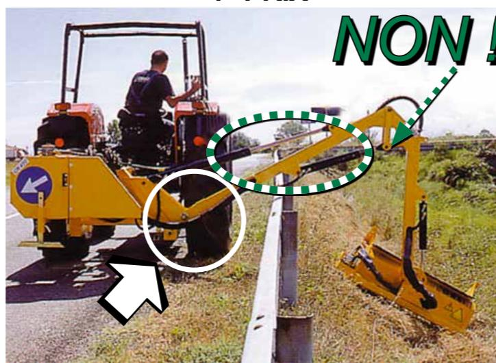
► Franchissement restreint à cause du vérin hydraulique à l'intérieur du compas et de l'axe décentré du vérin de levée.
