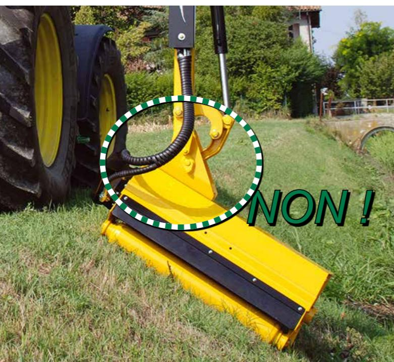
nt pas de contraintes occasionnées par un bras fixé au dessus, le groupe de broyage épouse parfaitement le du terrain et travaille librement en position fauchage. Angle important de travail en position taillage de haies.
