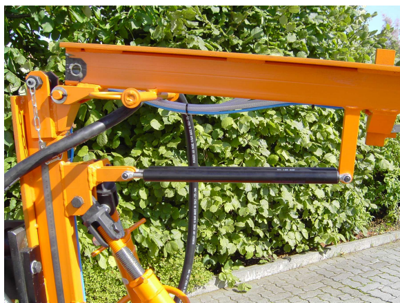
Ressord à pression de gaz pour mettre le mât facilement debout
