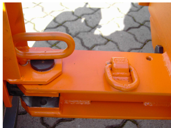
Oeillet pour suspendre le câble métallique
