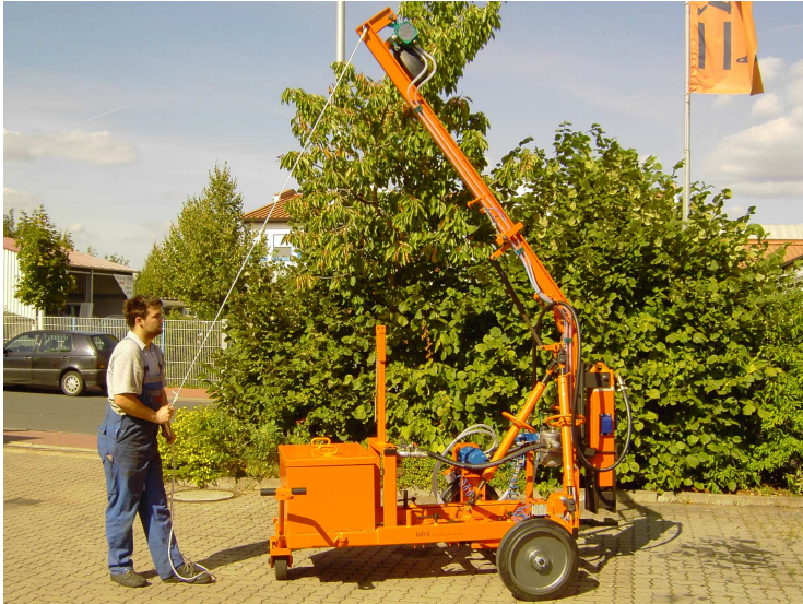
Soulever et/ou renverser le mât à l'aide d'un câble
