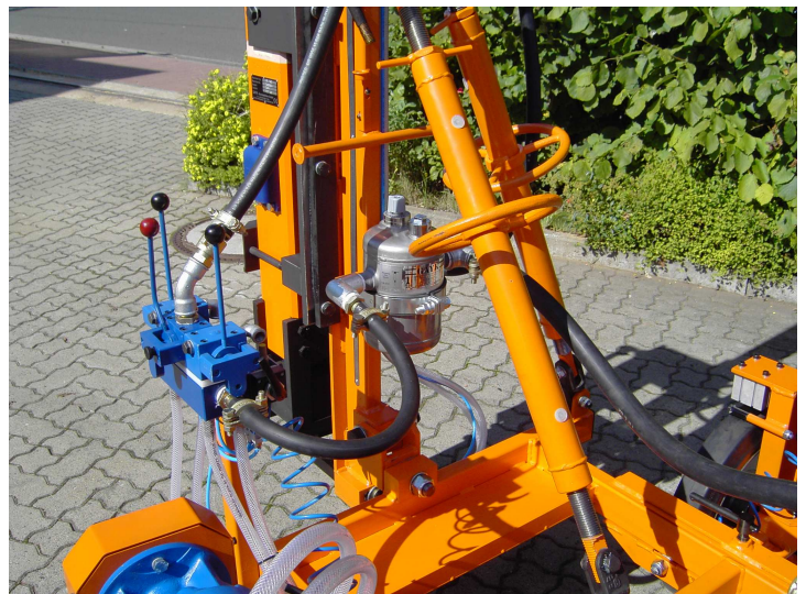
Tige de réglage, huileur de 4 litres, bloque de commande
