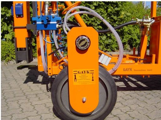
Entraînement avec moyeu à roue libre, frein à air comprimé et à garrot
