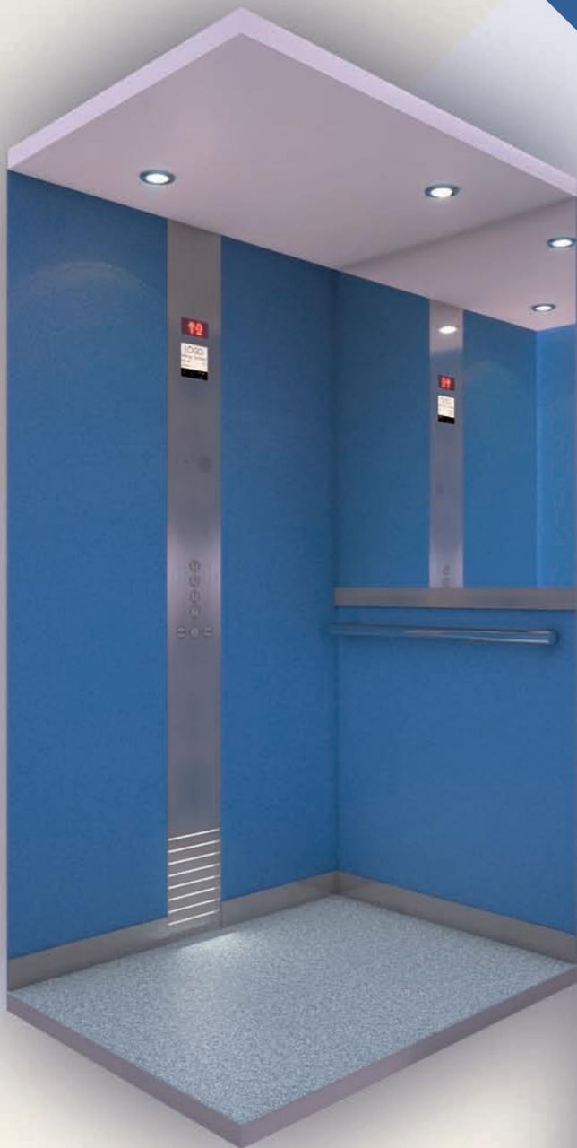
Plusieurs options sont disponibles pour les plafonds et l'éclairage. La configuration standard pour ces ascenseurs est un plafond peint en blanc ou en acier inoxydable brossé avec spots halogènes ou LED. Autres options: plafond en tôle perforée peint, plafond vitré ou acier inoxydable brossé, éclairage panneau\* de LED.
