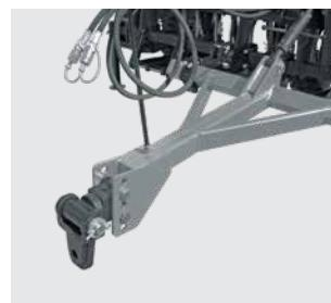
Cabeçalho de engate com jumelo articulado em dois eixos com três regulagens de altura.
