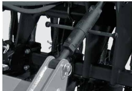
3º ponto para auxiliar o acoplamento ao trator e o nivelamento da máquina.
