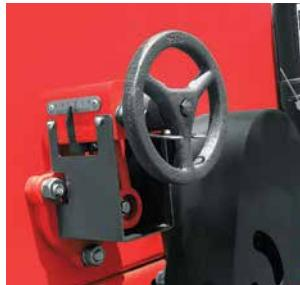
Volante helicoidal que permite a regulagem milimétrica do rotor com maior possibilidade de variações na distribuição de sementes.
