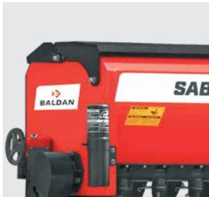
Depósito de sementes em aço carbono com tratamento epoxi.
