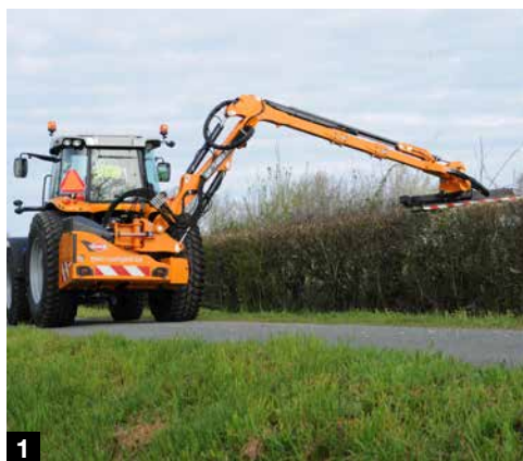
1 et 2. Faucheuses débroussailleuses (côté droit ou gauche) avec portées jusqu'à 7,40 m 3. Distributeurs de sel et de sable
