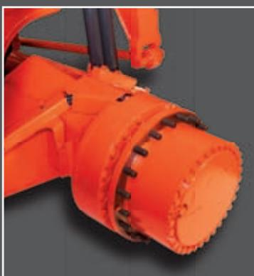
Les freins immergés refroidis par air du DA30 ne nécessitent pas de circulation forcée d'huile, au contraire de la plupart des concurrents.
