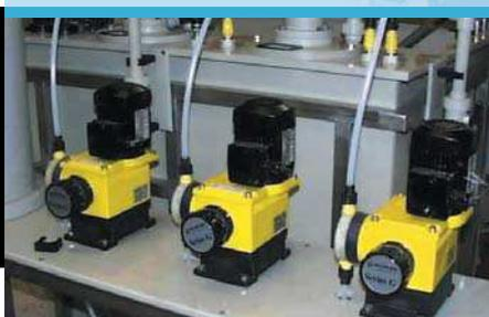
**Injection d'additif inorganique, de mouillant et de brillanteur pour une chaîne de traitement en continu de nickelage**
