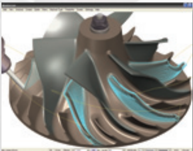
Des trajectoires parfaites sur les faces des aubes, bords d'attaque et bords de fuite ainsi que sur le moyeu.
