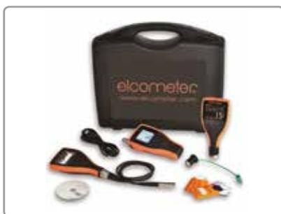
Ces kits d'inspection digitaux ont été spécialement conçus pour répondre aux trois principales exigences en matière d'inspection dans l'industrie des revêtements protecteurs et industriels : paramètres climatiques, profil de surface et épaisseur de film sec. Parfaits pour les systèmes d'assurance qualité "zéro papier", les kits sont livrés complets avec le logiciel de gestion des données ElcoMaster<sup>®</sup> qui génère des rapports d'analyse professionnels.
