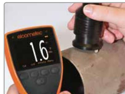
Sondes intégrées ou séparées pour mesures de profils jusqu'à 500µm (20mils) sur surfaces planes ou courbes\*\*
