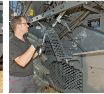
Collecteur de lubrification
