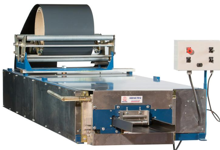
La profileuse à couverture fait suite aux boîtes à eaux et aux descentes déjà disponibles. Cette machine permet la fabrication en direct de couvertines à fixation invisibles en continu sur la longueur et réglable sur 3 largeurs différentes pour s'adapter à tous les murs.
