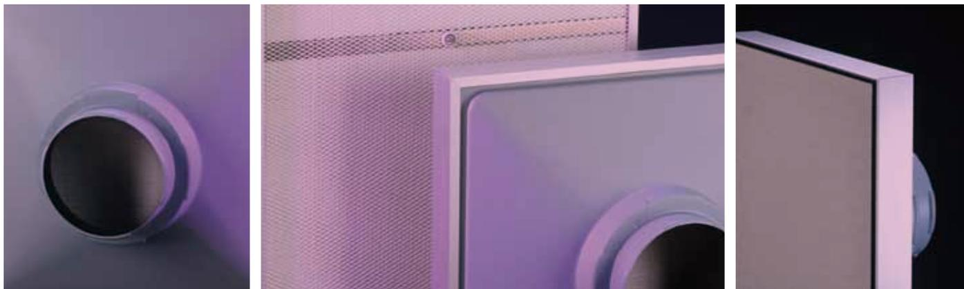
Le filtre type "JET" est un filtre H.E.P.A. ou U.L.P.A. (efficacité H14-U17) avec media plissé en miniplis et séparateur HOTMELT (ce qui réduit la perte de charge par rapport au débit) il est conçu pour la filtration de particules ultrafines en salles blanches.
