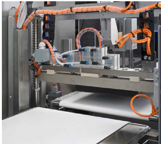
Soudure transversale à barres accompagnantes
