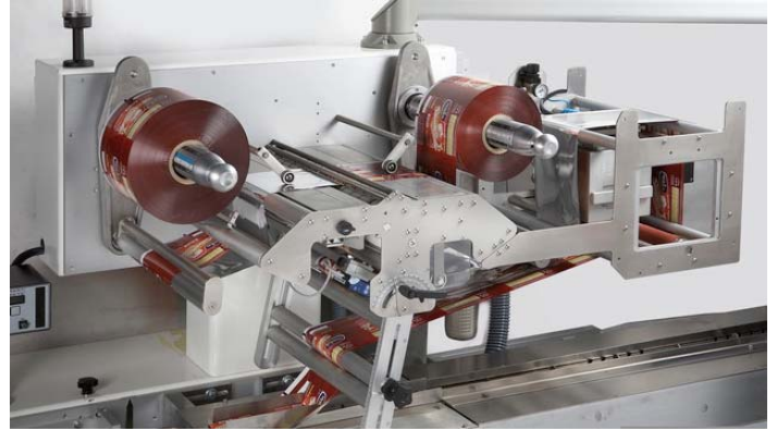
Double porte bobine à jonction automatique avec système de marquage sur machine bobine haute
