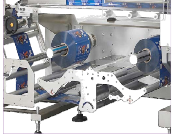
Double porte bobine à jonction automatique sur machine bobine basse
