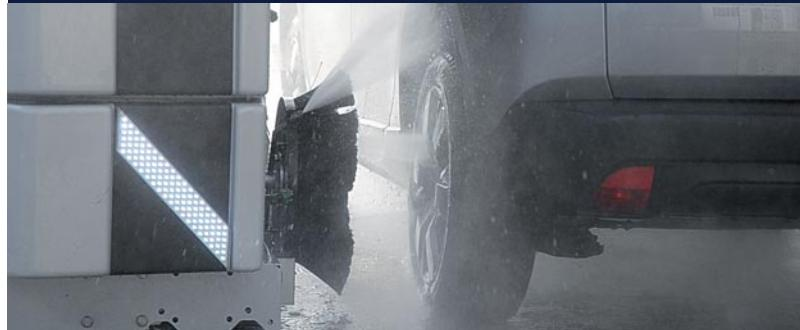
Die Höhe des Radwäschers ist einstellbar. Beim Annähern an das Rad senkt sich die Bürste um auch in kleine Felgen zu passen. Hochdruck ist im Radwäscher integriert, die Waschvorrichtung besteht aus drei innenliegenden Düsen. Diese sind bei der Felgenwäsche sehr effektiv und reinigen schwierig zu erreichende Zonen die von der Bürste nicht erreicht werden und waschen während der restlichen Wäsche die Unterseite des Fahrzeugs.
