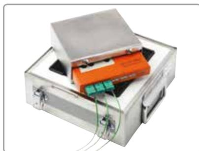
**Barrière thermique haute température**
