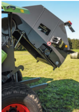
Un axe sur la porte arrière veille à sa fermeture correcte, même en pentes.
