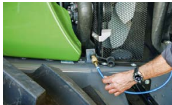
Un raccord d'air comprimé situé à l'avant permet de nettoyer le radiateur.
