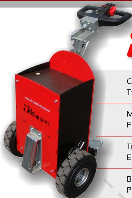
Capacité de traction : 1500 kg sur terrain plat
