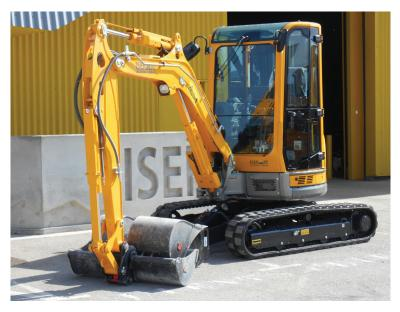
La ViO38-6 est une véritable mini-pelle à zéro déport qui permet une rotation complète du châssis supérieur dans la largeur des chenilles pour une sécurité maximale. Elle permet aux clients de travailler sereinement, notamment dans des milieux urbains où l'espace est très restreint.
